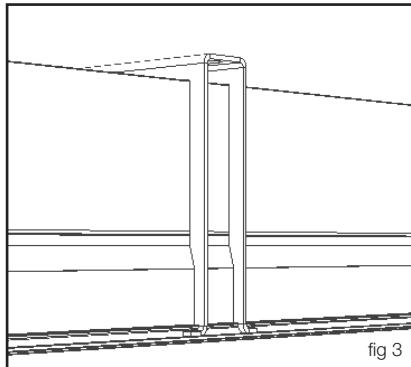
**SE:** Euroscreen® Freja2 är avsedd att installeras i tak, med eller utan gängstänger (dessa måste beställas separat).
